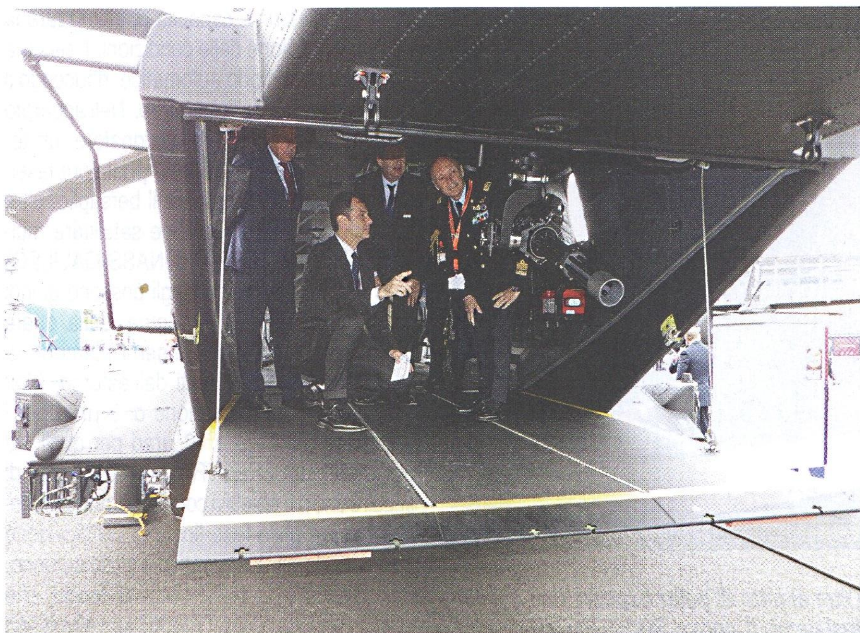
Il CSM dell'AM Gen. Vecciarelli all'interno dell'HH-101 osserva la Dillon M-134D a 6 canne rotanti tipo Gatling nella caratteristica predisposizione a scomparsa sulla parte interna del cielo della sezione di coda.
