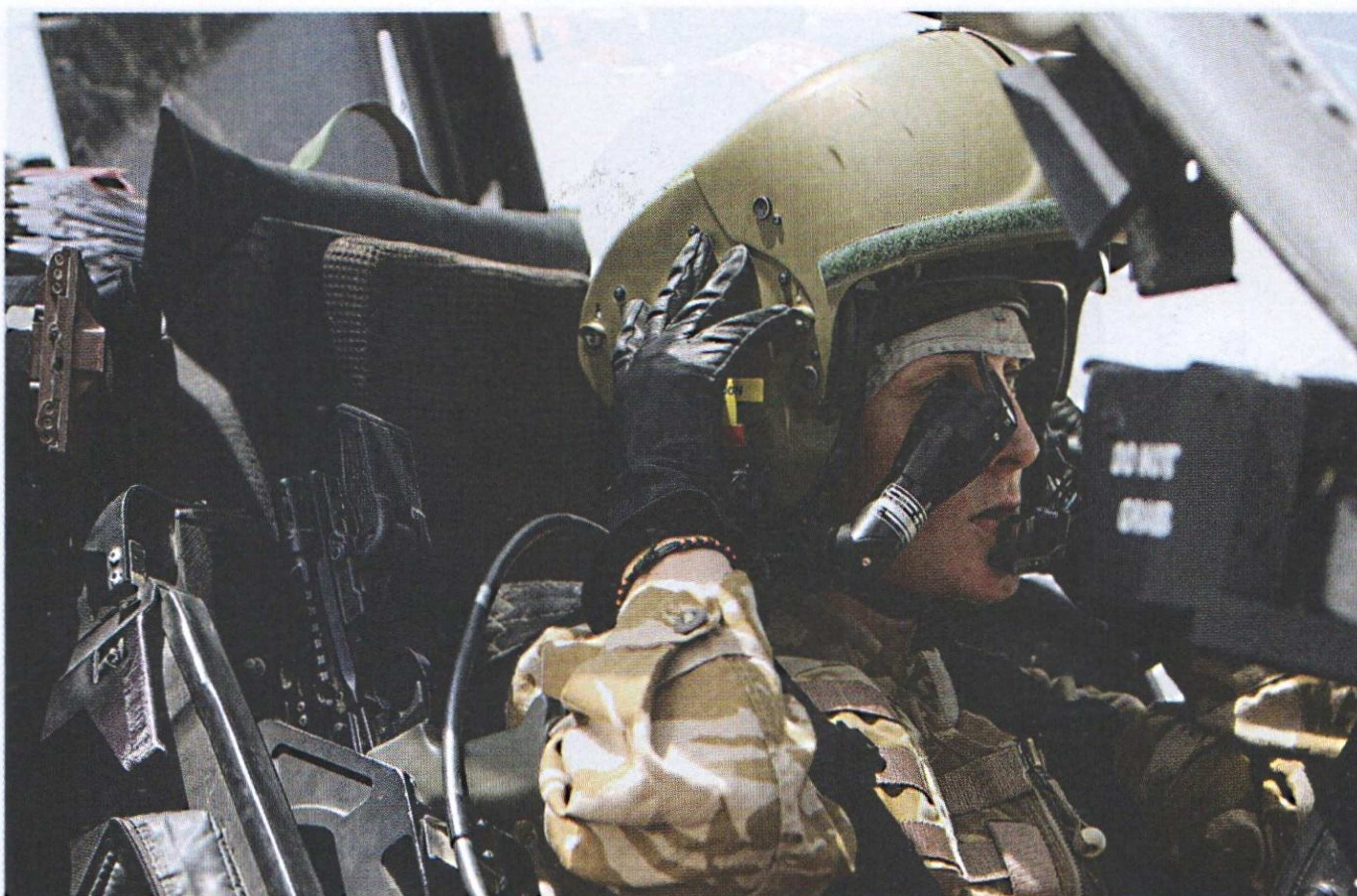
Il casco Honeywell IHADSS qui indossato da un pilota di AH-64 del 656 Sq. del British Army Air Corps a Camp Bastion (Afghanistan).
