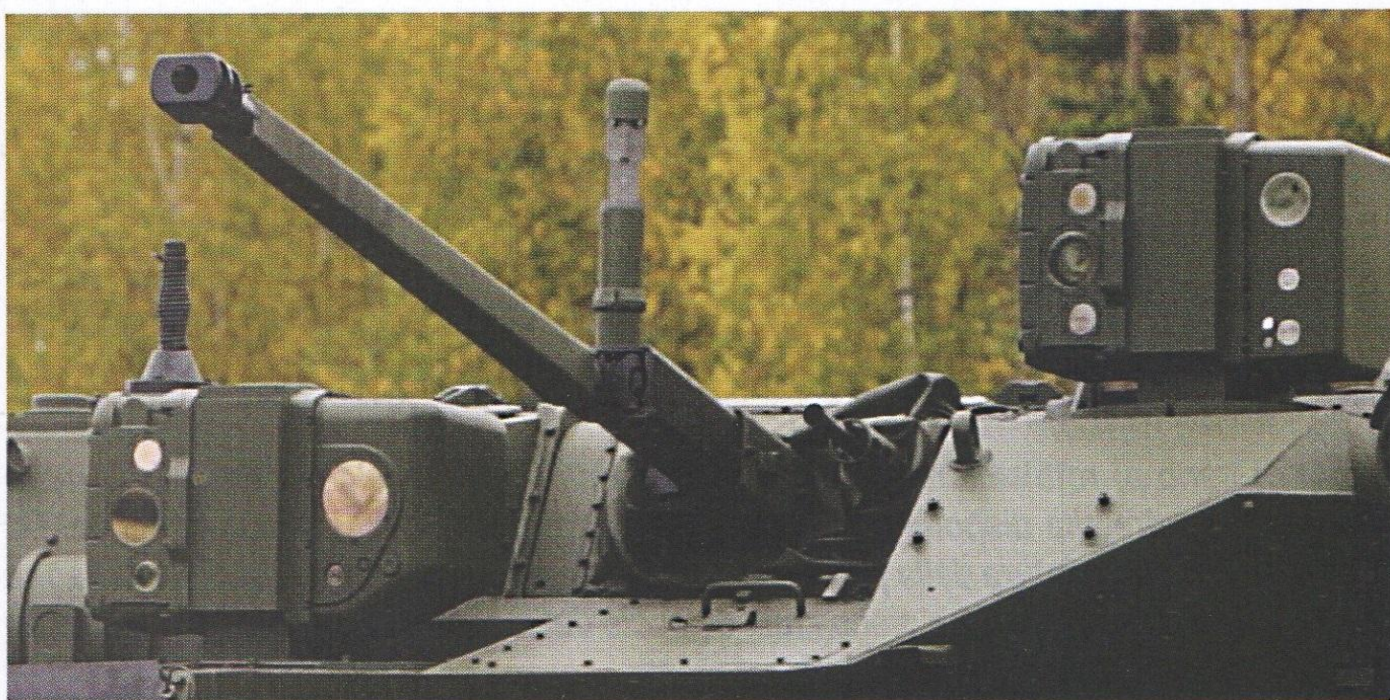
Particolare della torretta KBP Epoch con la mitragliera 2A42 da 30 mm, la mitragliatrice PKTM da 7,62 mm e i 2 sistemi elettro-ottici del capocarro (quello più in alto) e quello del puntatore.
