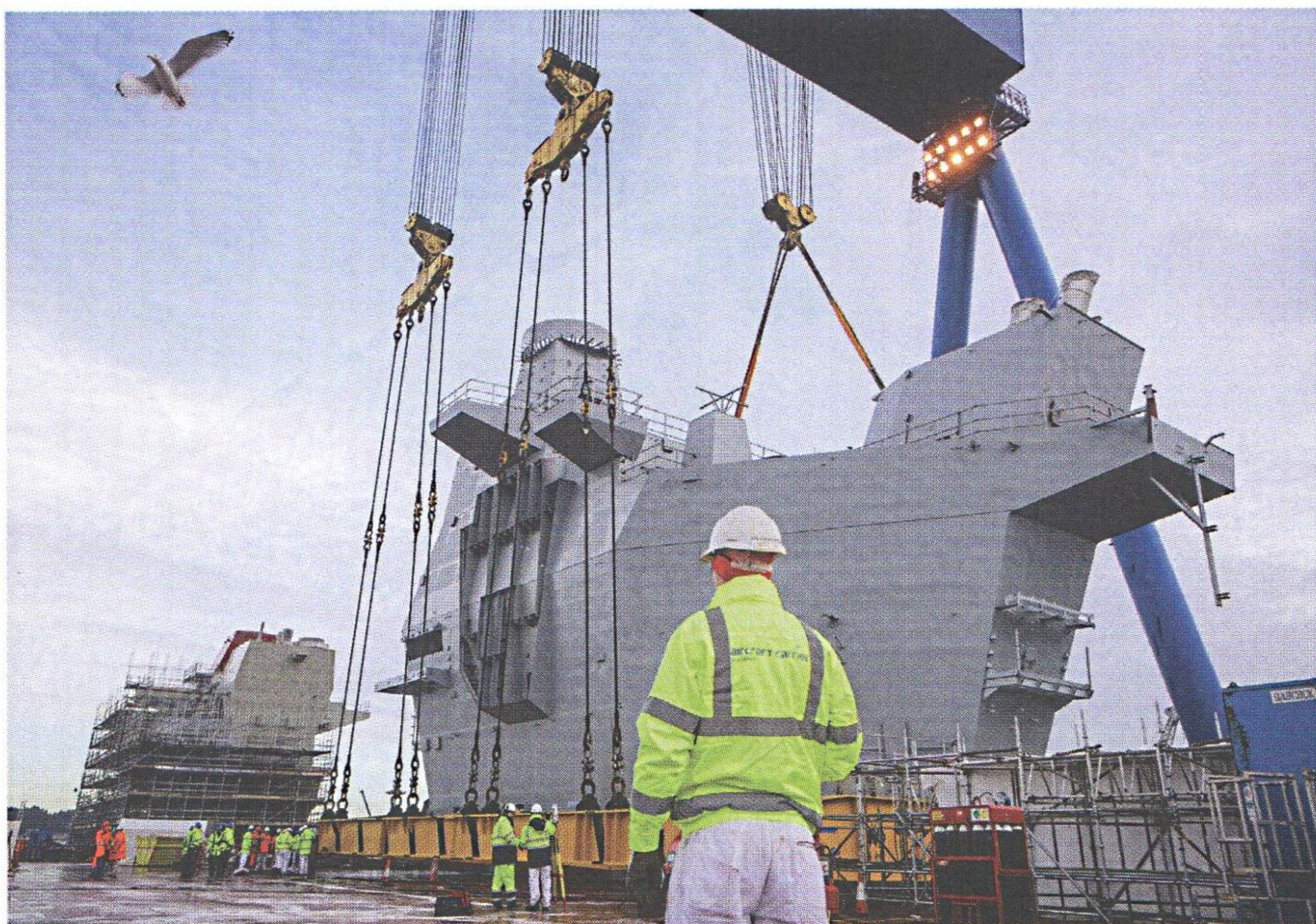
L'integrazione dei vari blocchi di costruzione delle 2 nuove portaerei STOVL della classe QUEEN ELIZABETH per la Royal Navy viene effettuata nel grande sito di Rosyth sul Firth of Forth, di proprietà della Babcock Marine. La foto mostra l'installazione del blocco da 750 t dell'isola posteriore (costruito dalla BAE Systems Naval Ships) sulla seconda unità, PRINCE OF WHALES, il 13 gennaio 2016. (Foto: Royal Navy)
