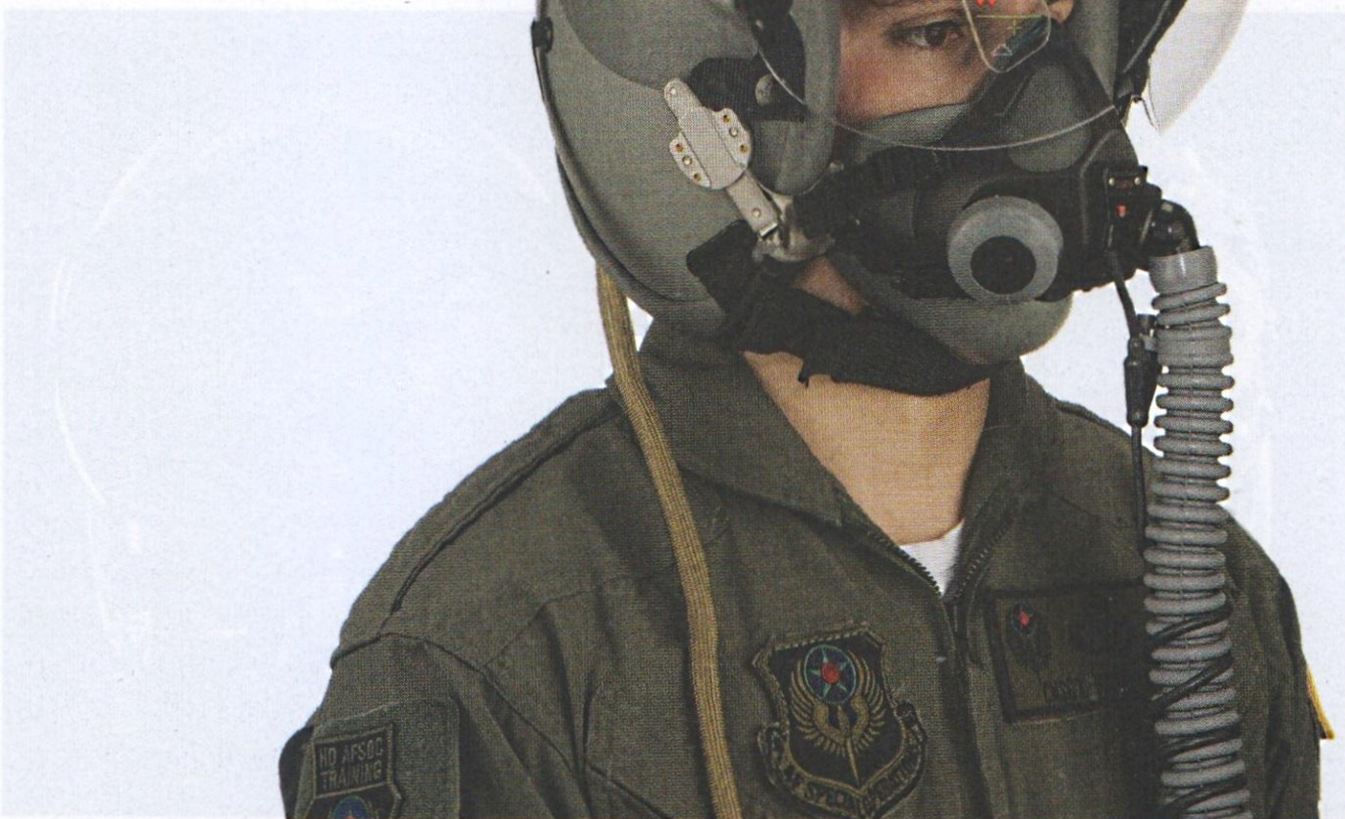
Il sistema HMCS SCORPION della Thales. Notare come tutto l'hardware è stato installato su un casco standard HGU 55/p. (foto: Thales)
