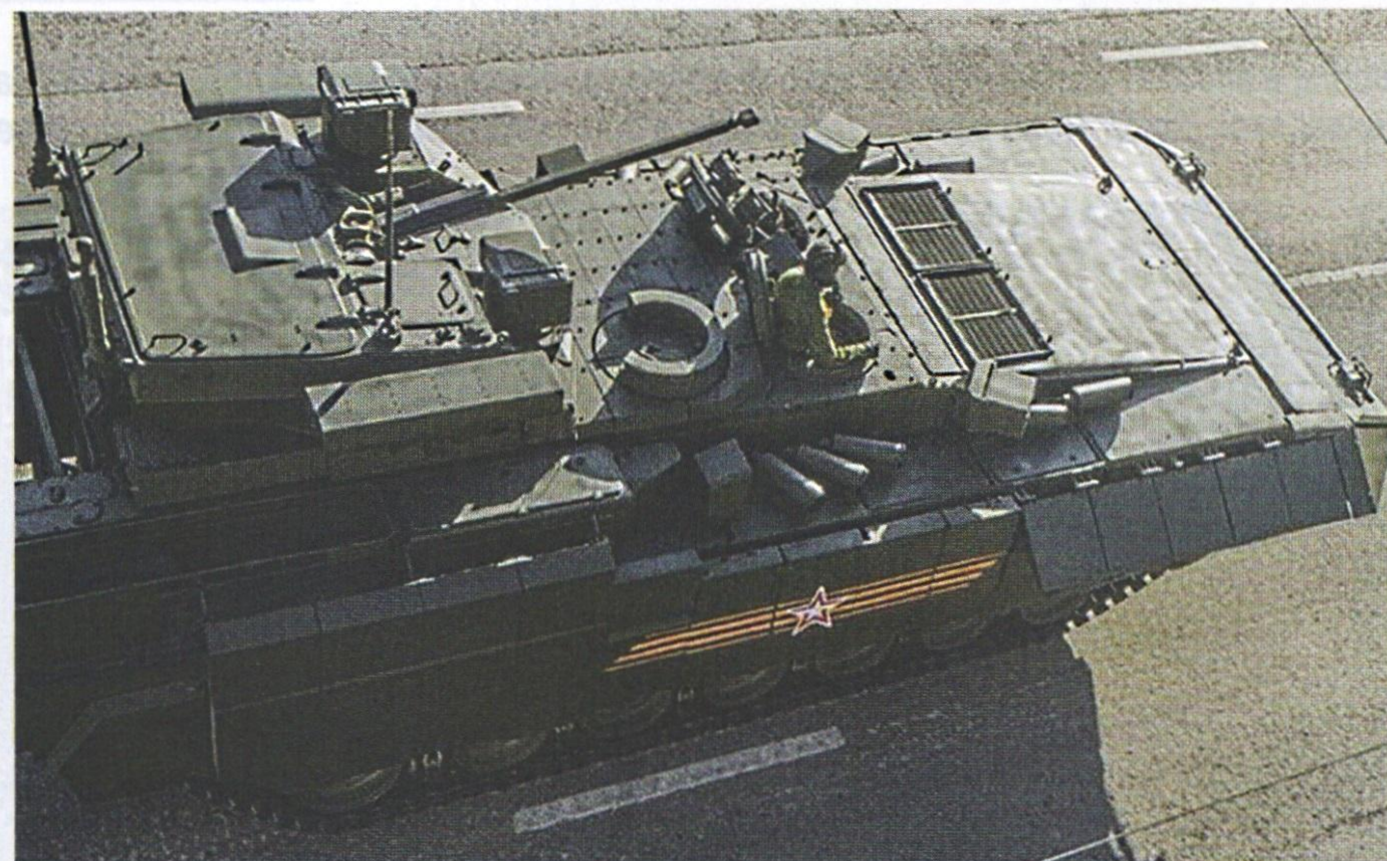
Sotto: vista da sopra di un T-15 che dà modo di apprezzare diversi dettagli della torretta nonché la sistemazione, molto centralizzata, delle postazioni del conduttore, del capo-carro e del puntatore.
