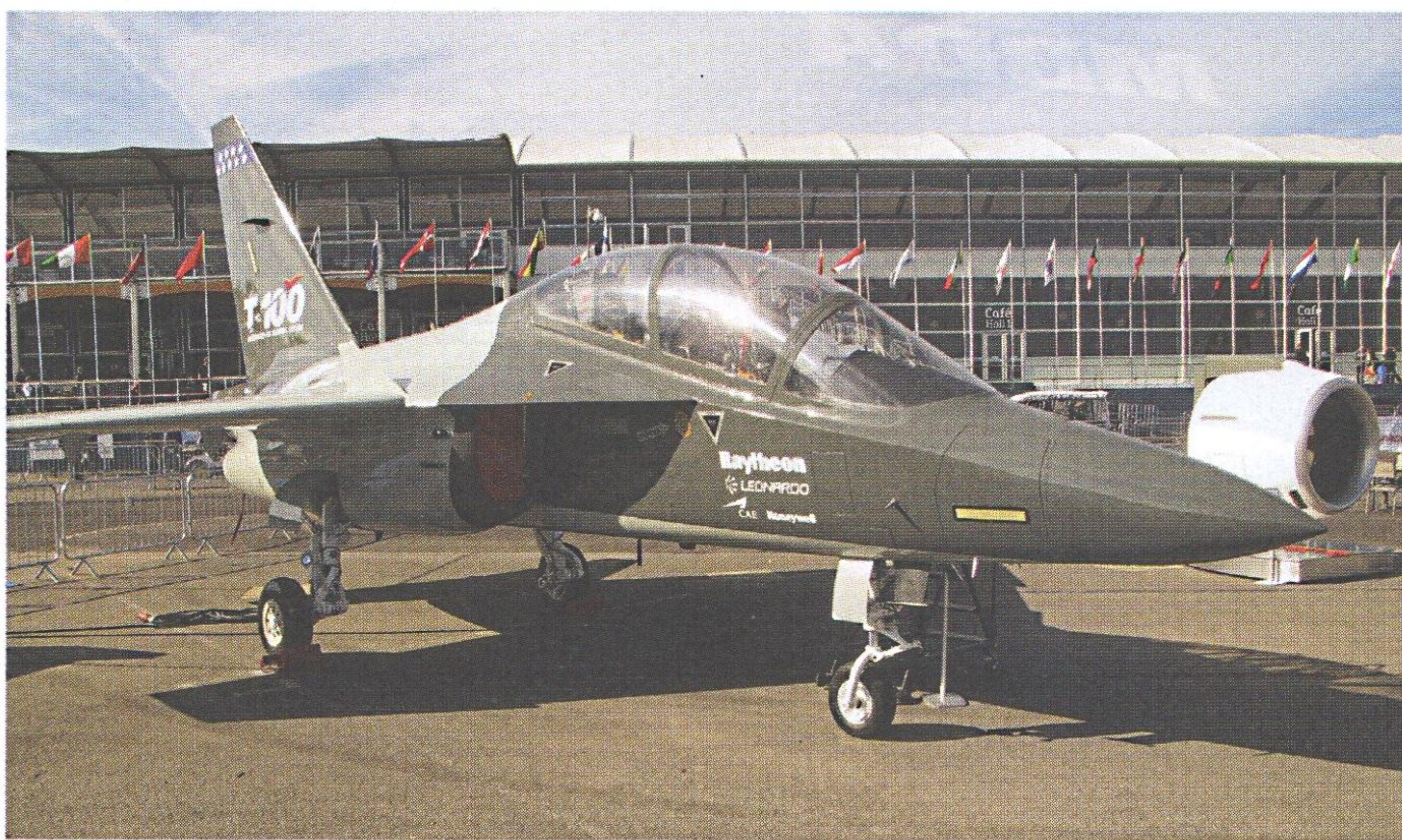
Il mock-up del T-100, la proposta di Leonardo e Raytheon basata sull'M-346 per il programma T-X dell'USAF.
